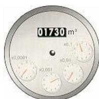
Il contatore o misuratore è lo strumento con cui si misura la fornitura dell'acqua che l'Utente consuma. L'Azienda fattura le forniture in metri cubi: 1 metro cubo (m<sup>3</sup>) equivale a 1.000 litri.
