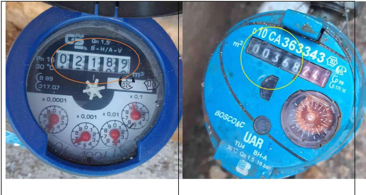
Per i contatori a **lettura indiretta** il quadrante con numeri di colore **nero** indicano i metri cubi, mentre i decimali sono di colore **rosso**. Vanno lette solo le lancette nere, da sinistra a destra. Se una lancetta si trova fra due numeri, si rileva il numero inferiore.
